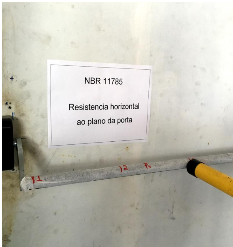
Foto n.º 03 – Visualização do ensaio de carregamento horizontal ao plano da folha.
